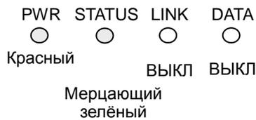
Такое состояние светодиодов, указанное выше, означает, что камера к кодеру подключена, но декодер не подключен. Как только подключение к декодеру будет установлено, светодиод «LINK» загорится зелёным цветом, а светодиод «DATA» будет мерцать при передаче данных.
