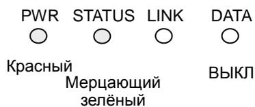
Состояние светодиодов, указанное выше, означает, что декодер не соединен с кодером. Как только подключение к кодеру будет установлено, светодиод «LINK» загорится зелёным цветом, а светодиод «DATA» будет мерцать при передаче данных.
